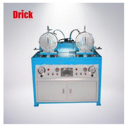
油封旋转性能试验机采用可编程控制系统,适用于各种回转式油封进行密封性能的试验和研究工作,油封安装在验机上,主轴以一定的速度回转,经过一定时间的运行,观察油封是否渗漏,每次可试验 2 件油封,测试轴可正、反转。
