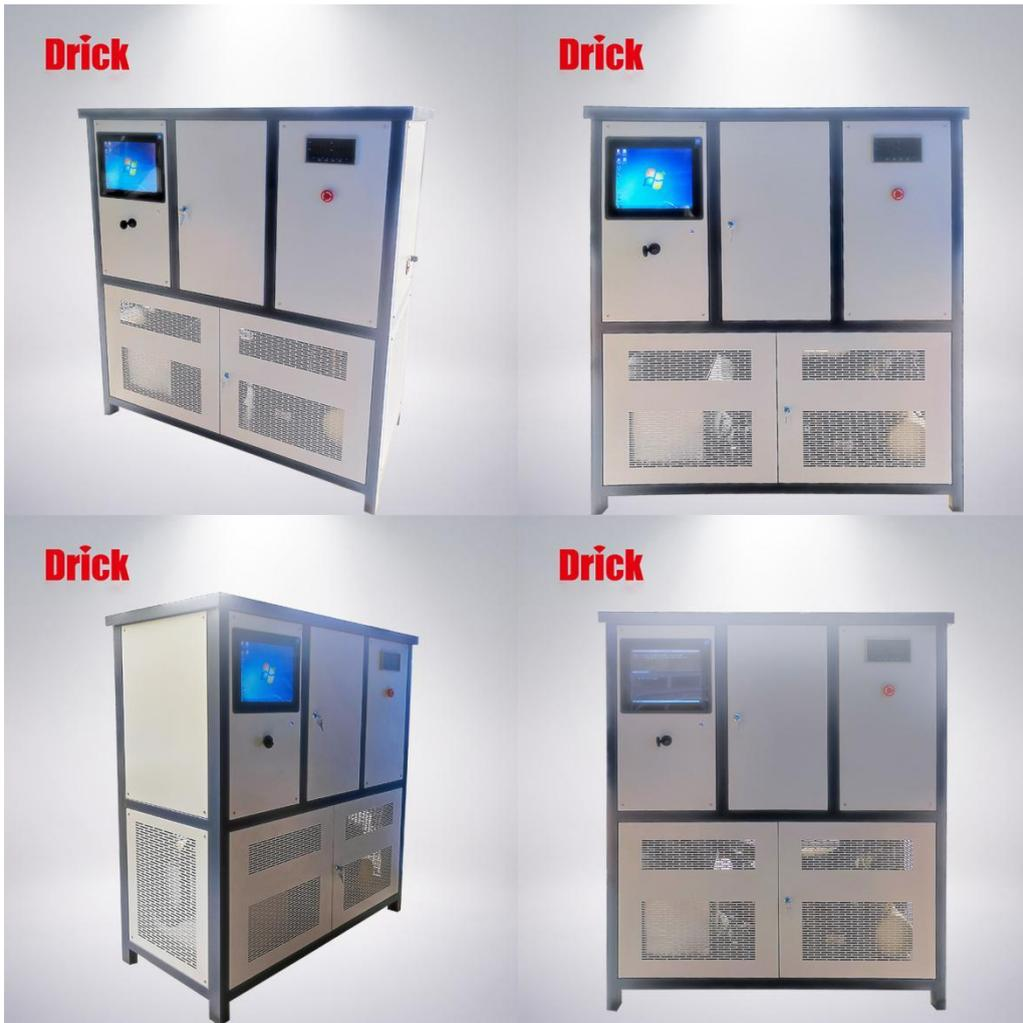
平板导热仪是按照 GB/T10294-2002 开发的中低温导热系数测定仪器。由热板、冷板、防护保温套、气动夹紧机构、控制器和测控软件等组成。本仪器采用防护热板法测定节能材料的导热系数，适用于建筑保温材料导热系数的测定。
