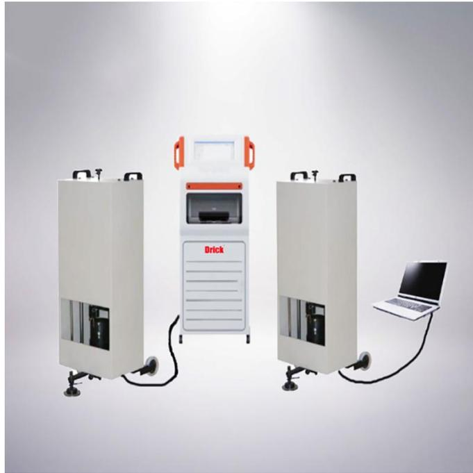
根据市场需求，德瑞克研发团队推出塑胶跑道垂直变形试验机系列产品，该产品主要应用于塑胶运动场地的冲击吸收性能和垂直变形性能的测试。塑胶跑道垂直变形试验机主要用于塑胶运动场地与冲击吸收性能的测定，机器重锤模拟人体作用效果冲击合成面层，通过计算机系统测算出试验结果。由计算机对其进行采样、处理、计算、分析等一系列过程，最终显示出作用于塑胶合成材料的冲击吸收和垂直变形的结果，从而测量塑胶材质的耐冲击及变形参数。仪器结构简单，操作方便。
