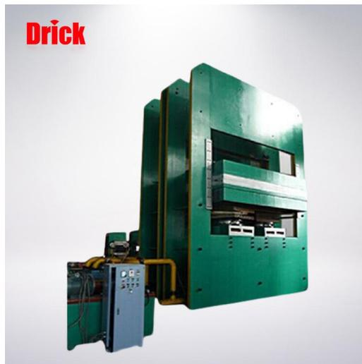
平板硫化机适用于各种橡胶制品的硫化，是各种热固性塑料压制成型的先进热压设备。平板硫化机有汽电两种加热型式，主要由主机、液压系统、电控系统三大部分组成，油箱单独安装在主机左侧，不受热板温度的影响；操作阀安装在主机左侧，工人操作方便、视觉宽敞。平板硫化机电控箱另行安装于主机之右侧。电热型每块电热板按有 6 根电热管，总功率为 3KW，6 根电热管为不等距排列，每根电热管各段功率不等，从而可保证热板温度均匀，热板温度自动控制，控温精度高，加工制品质量好。不掉压、不漏油、噪音小、精度高、操作灵活。自动上升，自动下降。自动排气。自动保压
