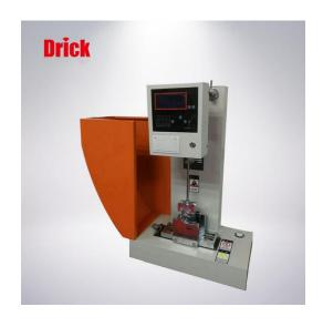
XJC-25D 型悬臂梁、简支梁组合冲击试验机:用于测定硬质塑料、增强尼龙、玻璃钢、陶瓷、铸石、塑料电器、绝缘材料等非金属材料的抗冲击强度,分为机械式(指针度盘)和电子式。
