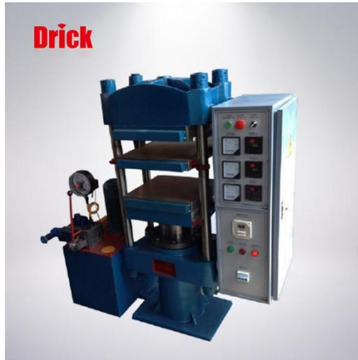
平板硫化机适用于各种橡胶制品的硫化，是各种热固性塑料压制成型的先进热压设备。平板硫化机有汽电两种加热型式，主要由主机、液压系统、电控系统三大部分组成，油箱单独安装在主机左侧，不受热板温度的影响；操作阀安装在主机左侧，工人操作方便、视觉宽敞。
