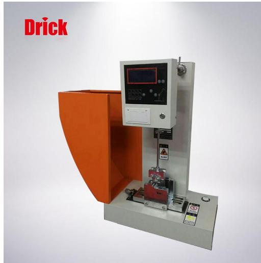
JC 简支梁冲击试验机用于测定硬质塑料、增强尼龙、玻璃钢、陶瓷、铸石、塑料电器、绝缘材料等非金属材料的抗冲击强度。具有精度高、稳定性好、测量范围大等特点；电子式采用圆光栅测角技术，除具有机械式冲的优点外，还可数字化测量显示冲断功、冲击强度、预仰角、升角、一批的平均值，能量损失自动修正。简支梁冲击试验机系列试验机可供科研机构、大专院校、各级产检所、材料生产厂等做简支梁冲击试验用。简支梁冲击试验机系列还拥有微控型，采用计算机控制技术，自动将试验数据处理形成打印报告，数据可以保存在计算机中，随时进行查询与打印。
