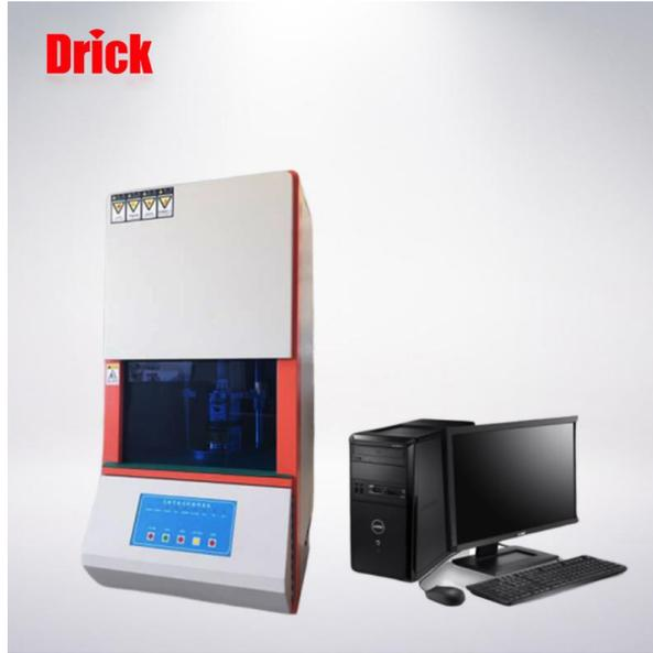
LH-B 型硫化仪采用电脑控制（DRICK 专用），进口温控仪进行精确控温，计算机适时进行数据处理并可进行统计、分析、存储对比等，人性化设计，操作简便，数据准确，为橡胶最优化配方提供最精确的数据。本硫化仪计算机上鼠标所点按键与主机面板上按键具有相同功能，以便于用户操作，计算机的软件界面相当良好，使用极为方便，用户可以精确的测出焦烧时间、正硫化时间、硫化指数、最大最小转矩等，是橡胶行业控制胶料质量，快速检验及橡胶挤出研究用的最理想设备。
